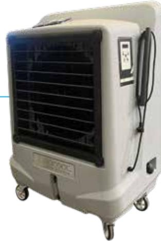
**Les rafraîchisseurs d'air 12 000 m<sup>3</sup>/h sont équipés d'un panneau évaporatif, d'un ventilateur et d'un système de circulation d'eau en cascade. Le ventilateur aspire l'air extérieur et le fait passer à travers un panneau en cellulose, constamment humidifié grâce à un système de pompage dédié.**
